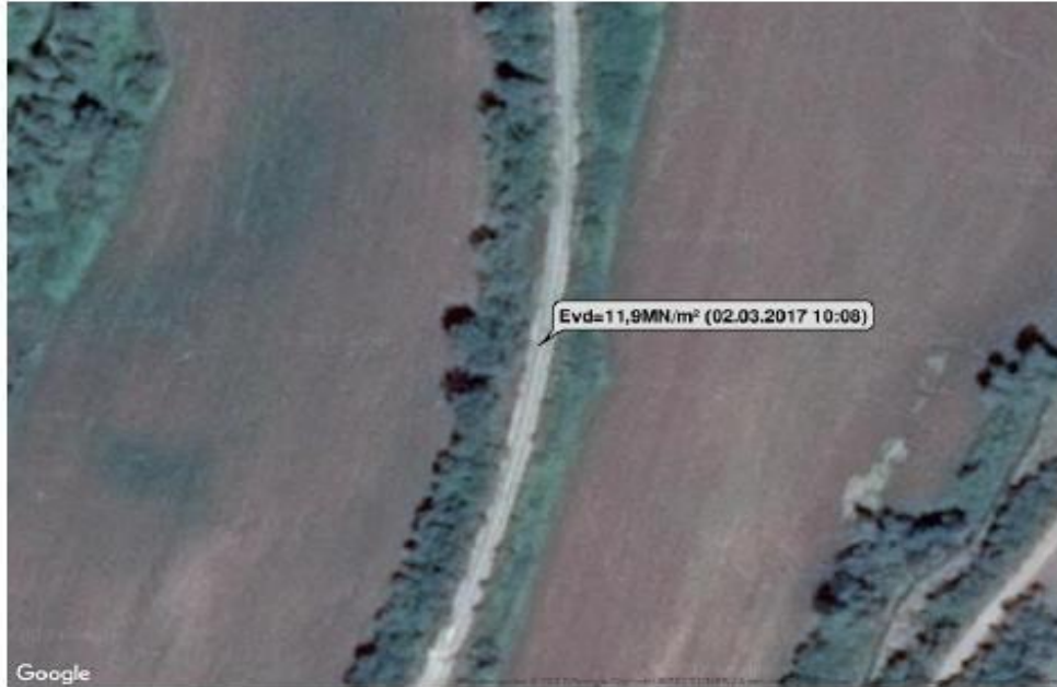
Figür-22 Uygulama öncesi Dinamik Plaka Yükleme Testi
