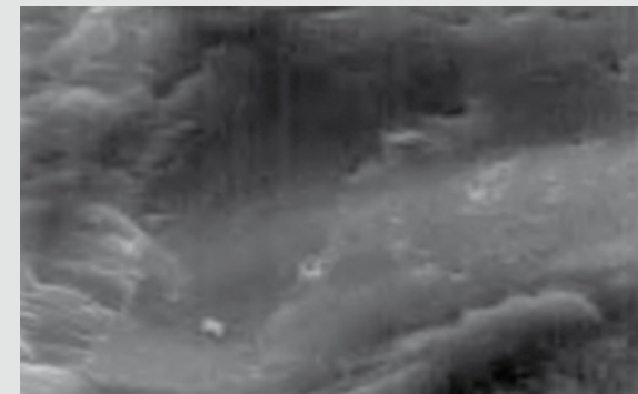
Цемент с NovoCrete®: закрытая плотная структура
