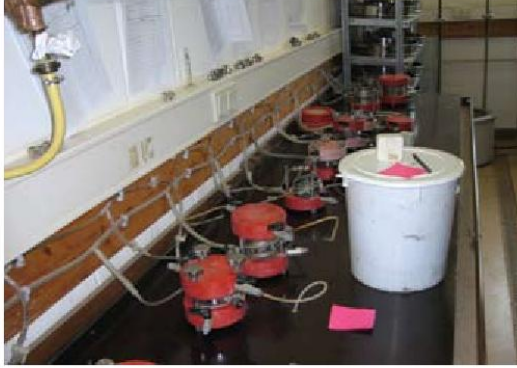
1 Toprak örneği alınması ve CBR değerinin ölçülmesi
